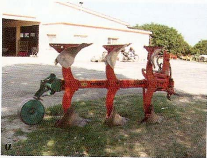
Εικόνα 5.8. Άροτρο με υνία (α) και δισκάροτρο (β).
