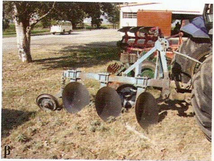
Εικόνα 5.8. Άροτρο με υνία (α) και δισκάροτρο (β).
