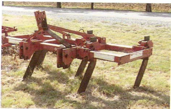
Εικόνα 5.12. Υπεδαφοκαλλιεργητής και εφαρμογή του μετά από καλλιέργεια ελαιοκράμβης.
