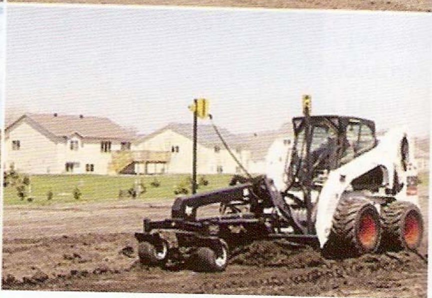
Εικόνα 5.3. Ισοπέδωση αγρού για την καλλιέργεια ρυζιού (φωτ. Η. Ελευθεροχωρινός).
