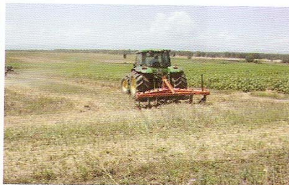
Εικόνα 5.12. Υπεδαφοκαλλιεργητής και εφαρμογή του μετά από καλλιέργεια ελαιοκράμβης.
