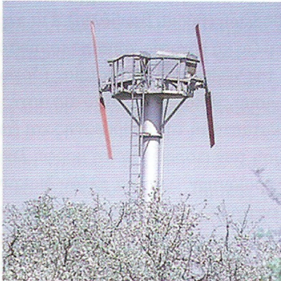
Εικόνα 4.9. Θερμάστρες και αερομείκτες που χρησιμοποιούνται για την αντιμετώπιση των παγετών.
