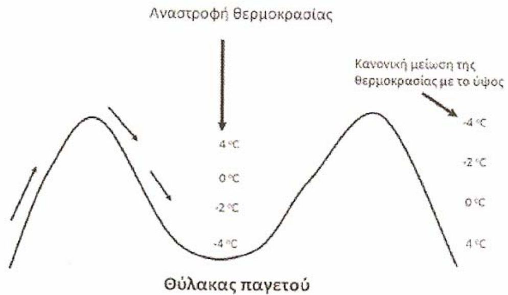
Σχήμα 4.25. Κανονική μεταβολή και αναστροφή της θερμοκρασίας του αέρα με το ύψος.
