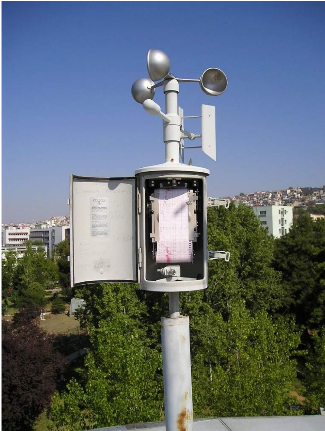
Εικόνα 7.2 Ανεμόμετρο με ανεμοδείκτη.
