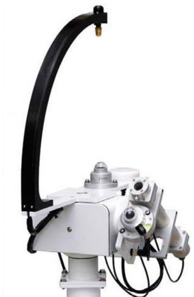
Εικόνα 3.1 Πυρανόμετρο που χρησιμοποιείται για την μέτρηση της ολικής ηλιακής ακτινοβολίας.
