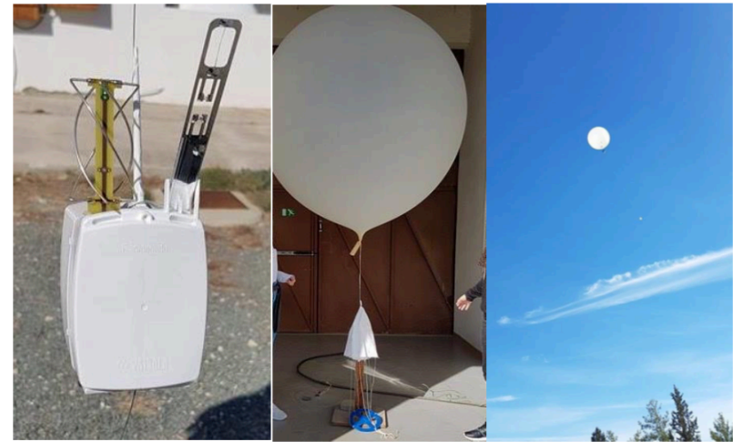
Σχήμα 9: Φωτογραφίες από την εκτόξευση της ραδιοβολίδας στην παρουσία μας. Στην πρώτη φωτογραφία φαίνεται η ραδιοβολίδα στη μεσαία το μπαλόνι πριν εκτοξευθεί και στην δεξιά το μπαλόνι σε κάποιο ύψος με την ραδιοβολίδα.
