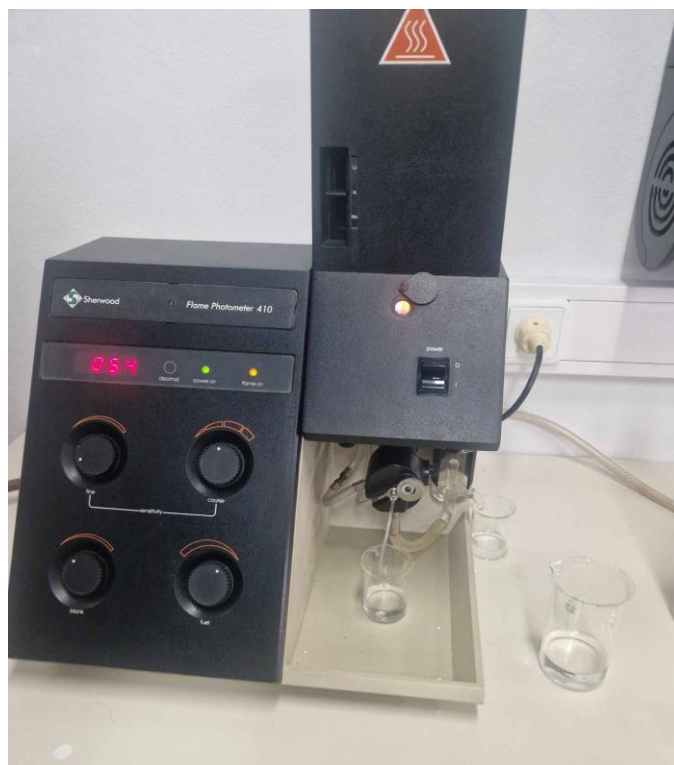
Εικόνα 3: Ένδειξη φλογοφωτόμετρου για το διάλυμα καλίου 1000 ppm (υπάρχει κάλιο επομένως η φλόγα γίνεται πορτοκαλί)
