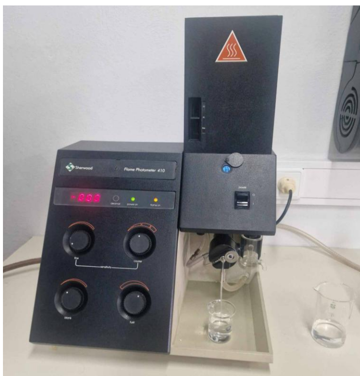
Εικόνα 2: Ένδειξη φλογοφωτόμετρου για το διάλυμα γνωστής συγκέντρωσης καλίου 0 ppm (δεν υπάρχει κάλιο επομένως η φλόγα παραμένει μπλε)
