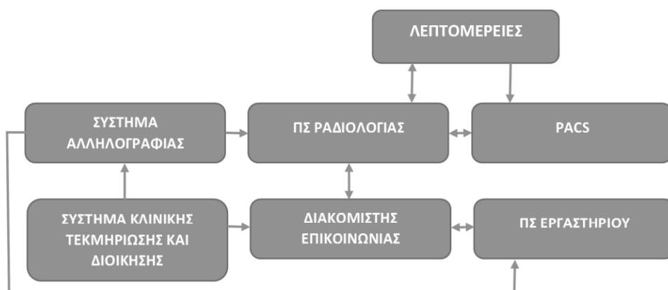
Εικόνα 3.1 Ένα απόσπασμα ενός πραγματικού τεχνικού μοντέλου ΠΣΥ με μερικά υποσυστήματα και τις διασυνδέσεις επικοινωνίας ενός ΠΣΝ.
