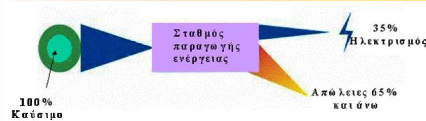
Τυπικό συμβατικό σύστημα παραγωγής ηλεκτρικής ενέργειας
