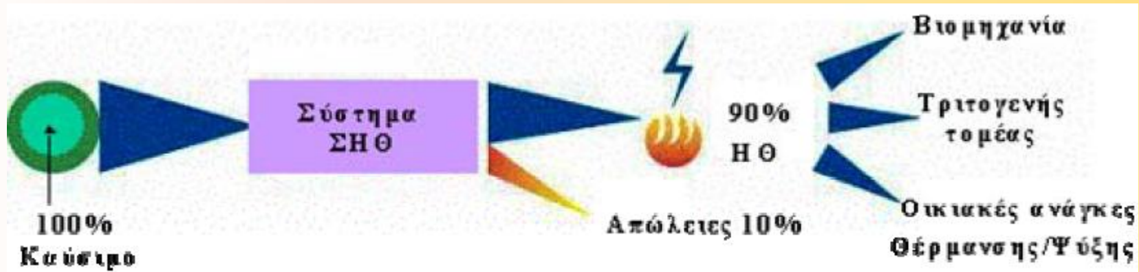
Τυπικό σύστημα Συμπαγωγής Ηλεκτρισμού και Θερμότητας
