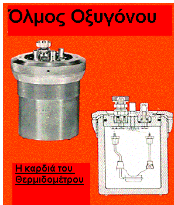
Σχήμα 5. Τομή του όλμου του Θερμιδόμετρου. Διακρίνονται καθαρά το σύρμα ανάφλεξης και το χωνευτήριο.
