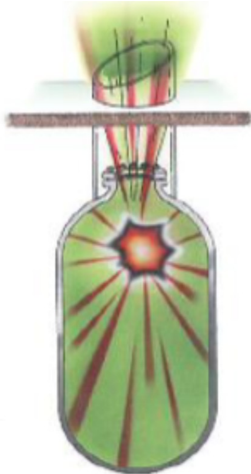
Εκτόνωση έκρηξης με βαλβίδα εξόδου στην ατμόσφαιρα
