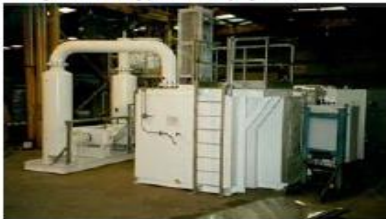
Καταλυτικός μετακαυστήρας VOC.
