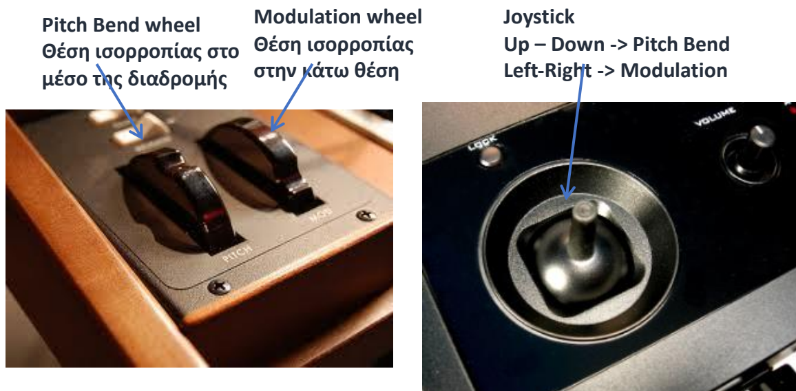
Σχήμα 7-5: Pitch Bend και Modulation Controller σε μορφή τροχών ή joystick.
