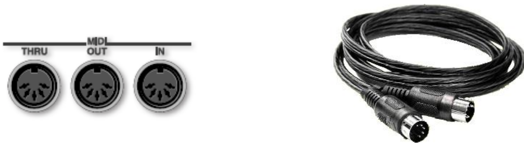
Σχήμα 5-4: MIDI Θύρες και καλώδιο MIDI
