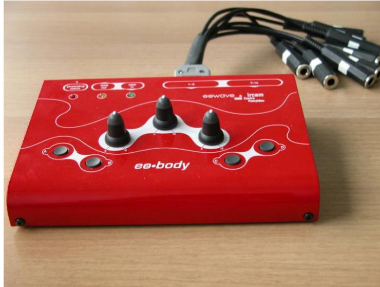
Σχήμα 4-8: Ο eobody voltage-to-MIDI converter.
