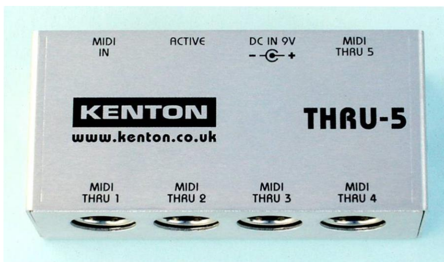
Σχήμα 5-13: MIDI THRU box.
