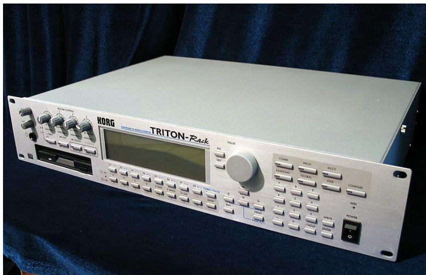
Σχήμα 4-9: Korg Triton rack-mountable sound module.
