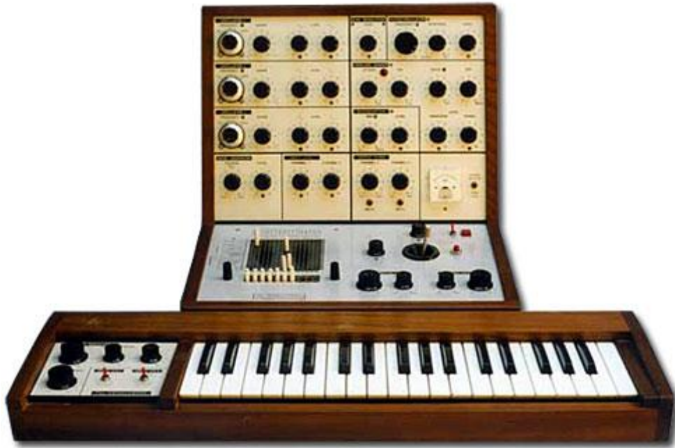
Σχήμα 3-5: Το VCS3. Κατασκευάστηκε το 1969. Αποτελείται από τρεις ταλαντωτές και ένα matrix-based σύστημα συνδέσεων (patch).
