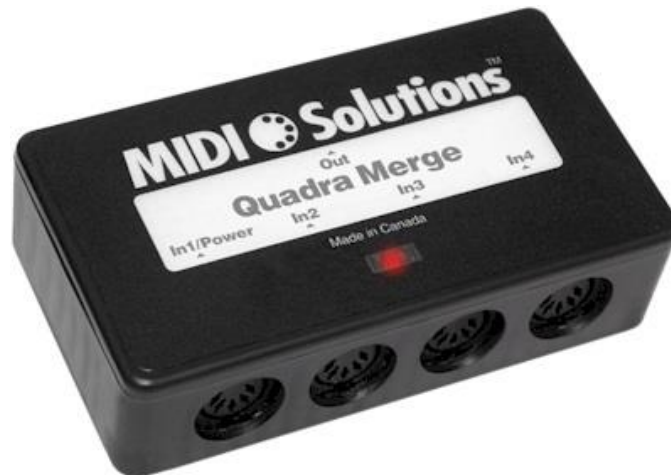
Σχήμα 5-14: MIDI Merger τεσσάρων εισόδων.
