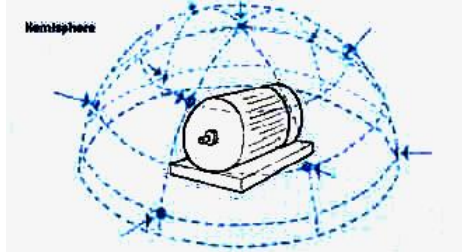
Σχήμα 9. Μέτρηση ηχητικής ισχύος σε ημισφαιρική επιφάνεια γύρω από την πηγή ήχου [11]
