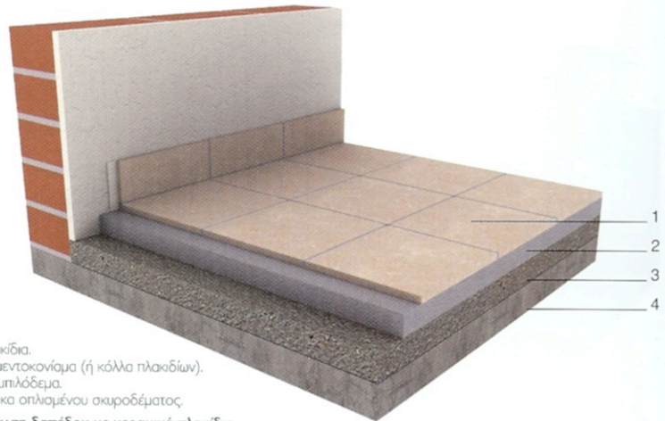
Επίστρωση δαπέδου με κεραμικά πλακίδια.
