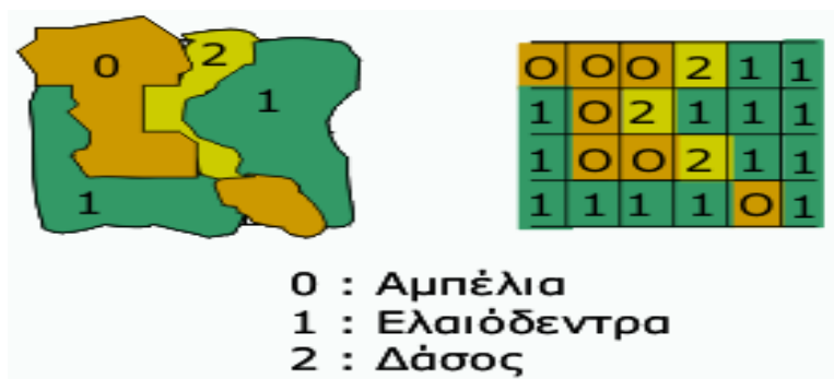
Σχήμα 6. Παρουσίαση δεδομένων σε μορφή διανύσματος (αριστερά) και σε μορφή κανάβου (δεξιά)
