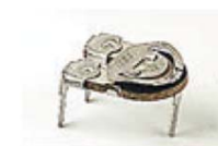
Σχ. 4/5 Ρυθμιζόμενος αντιστάτης με βιδολόγο
