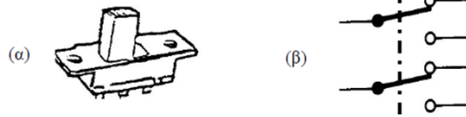
Σχ. 4/15 Εικόνα (α) και σύμβολο (β) συρόμενου διακόπτη
