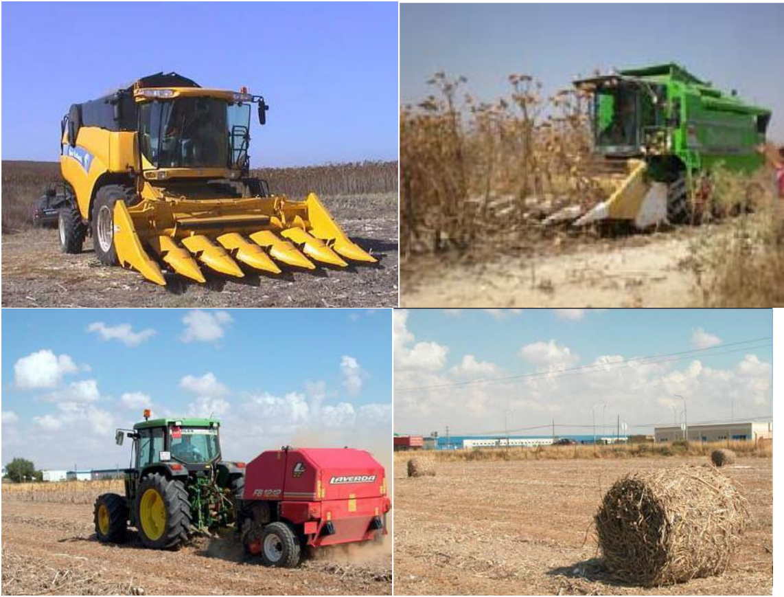
Εικ. 2. Συγκομιδή αγριοαγκινάρας. Θερμιστικές μηχανές με καλαμπομάχαιο (πάνω αριστερά) και ηλιομάχαιο (πάνω δεξιά). Δεματοποίηση βιομάζας (κάτω αριστερά) και δεματοποιημένη βιομάζα (κάτω δεξιά).
