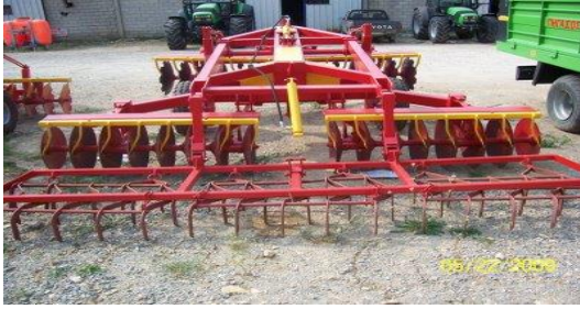
Εικόνα 8: Δισκοσβάρνα (αριστερά) και Σβωλοκόπτης (δεξιά)
