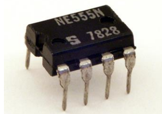
Συσκευασία DIP (Dual In Line Package)
