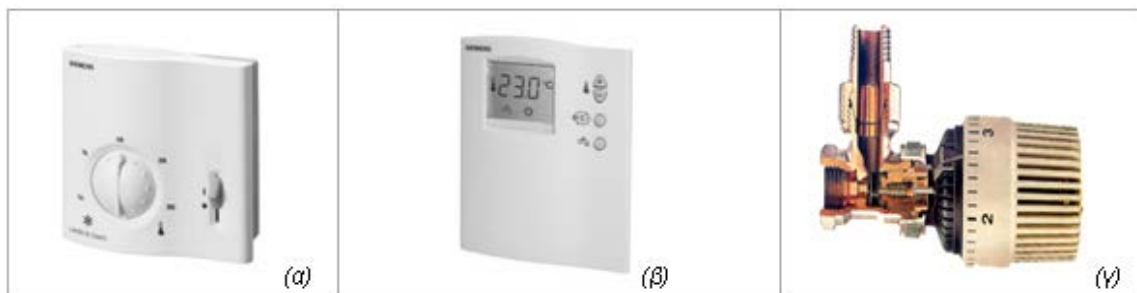
Σχήμα 1.5.3.2 Θερμοστάτες διαφόρων τύπων. (α) Ηλεκτρομηχανικός με διακόπτη on/off, (β) ηλεκτρονικός με χειροκίνητη εντολή παραγωγής ζεστού νερού χρήσης, (γ) θερμοστατικός διακόπτης
