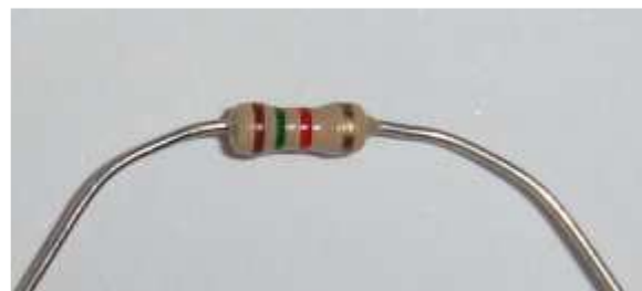
Ηλεκτρική αντίσταση άνθρακα, ονομαστικής τιμής 1,5 kΩ, 0.5 Watt.
