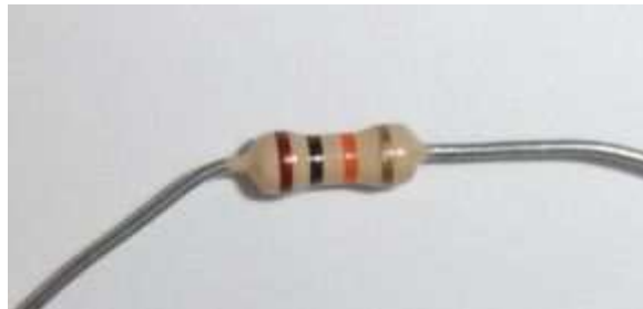
Ηλεκτρική αντίσταση άνθρακα, 10KΩ, 0.5 Watt.
