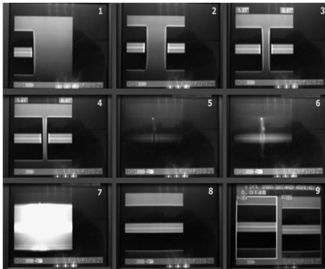
Συσκευή για την κοπή Ο.Ι. (πάνω) και στιγμιότυπα από την κόλληση (κάτω)
