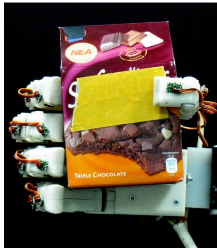
Εικόνα 4.3.1 Ευσταθής λαβή χάρτινου κουτιού
