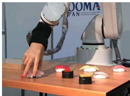
Εικόνα 1.5.4 Η χρήση του ρομποτικού χεριού Robot Hand G type σε ρομποτικό βραχίονα
