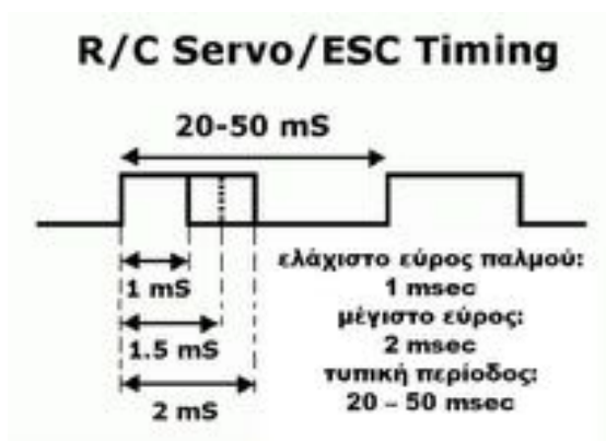
Εικόνα 4.1.4 Εύρος παλμών του κινητήρα τύπου «RC SERVO»
