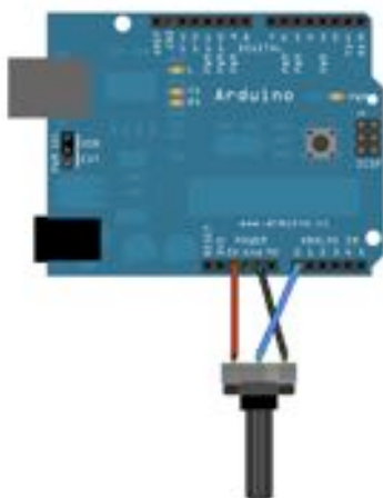
Εικόνα 3.6.2 Συνδεσμολογία αναλογικού περιστροφικού ποτενσιόμετρου με τον Arduino Uno
