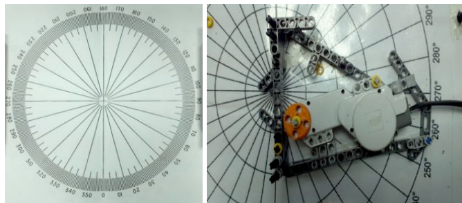
Εικόνα 3.3 Η βάση στήριξης της κατασκευής, μόνη και μαζί με τον κινητήρα “NXT”
