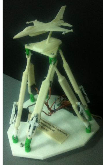
Εικόνα 5.2.3.1.: μέγιστη μετακίνηση κατά τον άξονα των z έως την αρχική ή ελάχιστη θέση της πλατφόρμας
