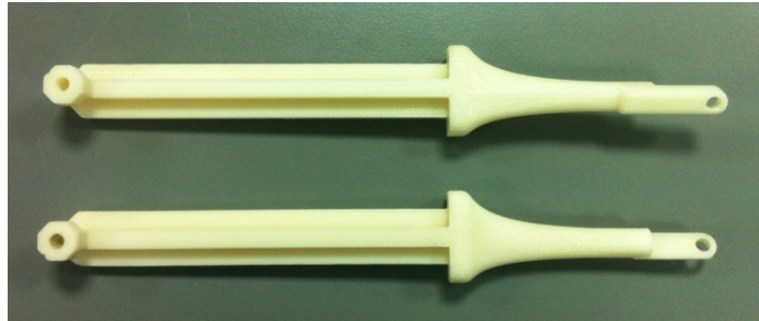
Εικόνα 3.1.2.3.2.2.: κατασκευασμένοι κινητοί σύνδεσμοι πρισματικής άρθρωσης (δρομείς)
