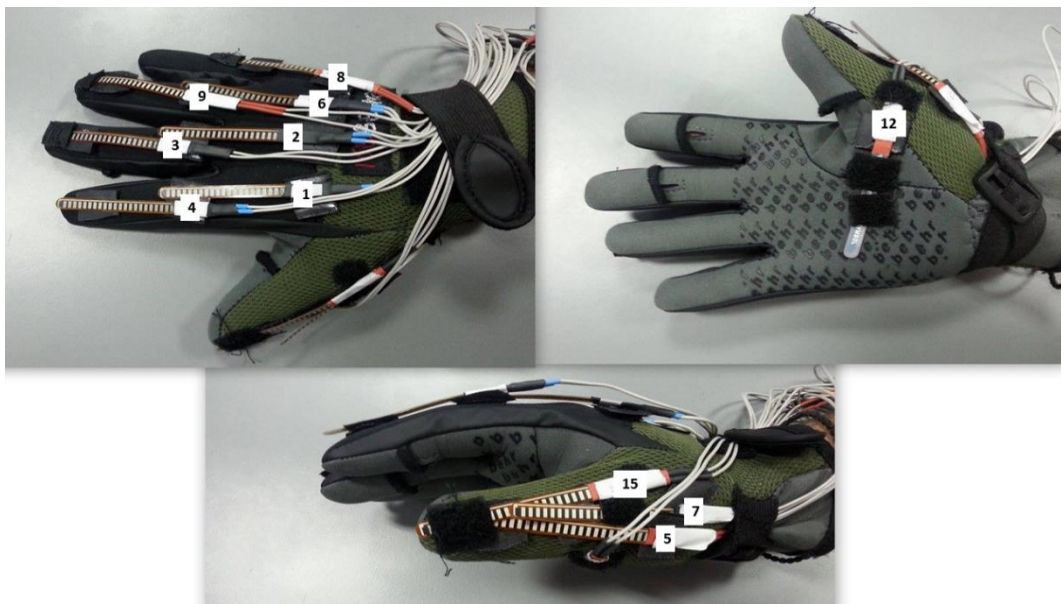
Εικόνα 4.1. Απεικόνιση της διάταξης των αισθητήρων πάνω στο γάντι.
