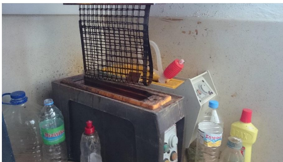
Εικόνα 0.6. Μηχάνημα που περιέχει χλωριούχο σίδηρο για την αφαίρεση του ανεπιθύμητου χαλκού από την πλακέτα.
