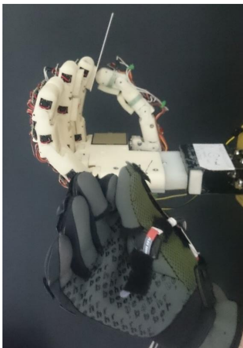
Εικόνα 5.31. Ευσταθής λαβή κάρτας με το ρομποτικό χέρι και το γάντι συλλογής δεδομένων.
