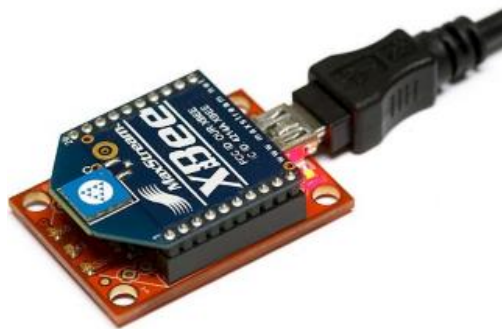
Εικόνα 5.10. Παράδειγμα σύνδεσης του XBee Explorer Dongle με τον υπολογιστή.
