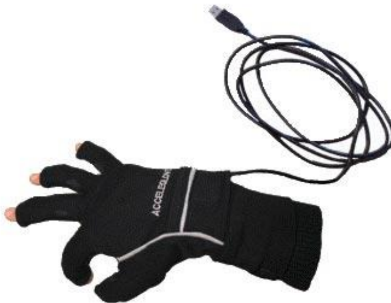
Εικόνα 2.9. Γάντι συλλογής δεδομένων AcceleGlove.
