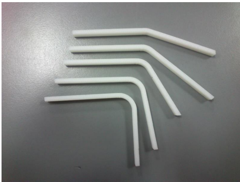
Εικόνα 4.4. Εκτυπωμένες επιφάνειές από τον τρισδιάστατο εκτυπωτή με ακτίνα καμπυλότητας 15mm.
