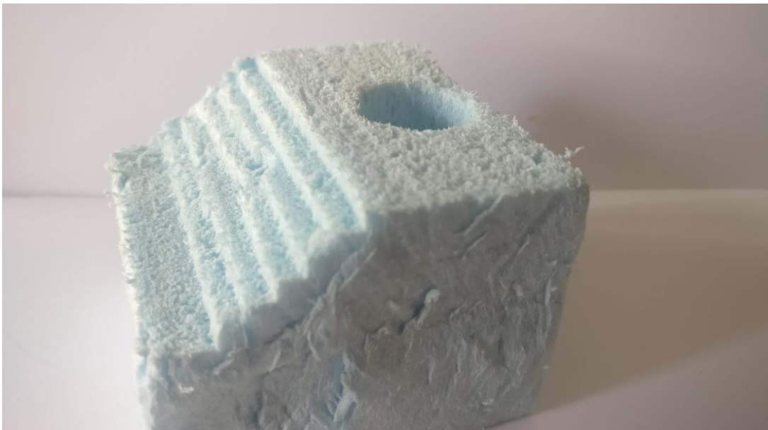
Εικόνα 56 Αποτελέσματα κατεργασίας τριών αξόνων και τη χρήση κυκλικών κινήσεων.
