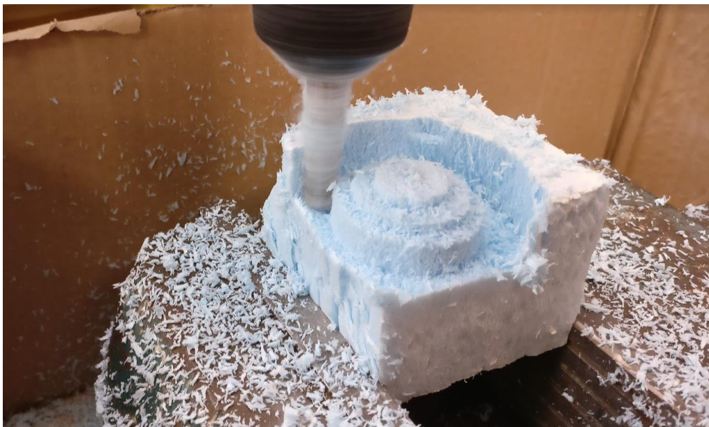
Εικόνα 51 Εκτέλεση κυκλικών κινήσεων για κατεργασία τριών αξόνων
