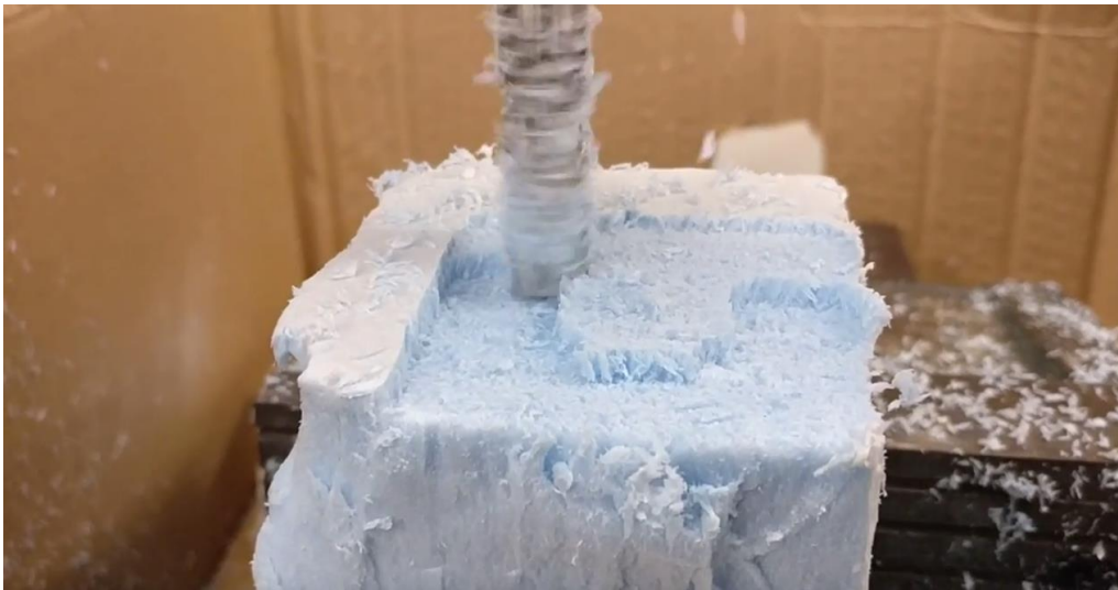
Εικόνα 50 Εκτέλεση γραμμική κατεργασία τεμαχίου παραλείποντας τα επιθυμητά μέρη
