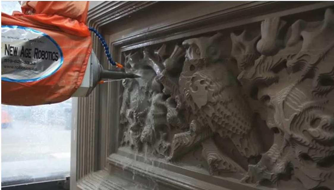
Εικόνα 21 Γλυπτική πέτρας με τη χρήση ρομποτικού βραχίονα
