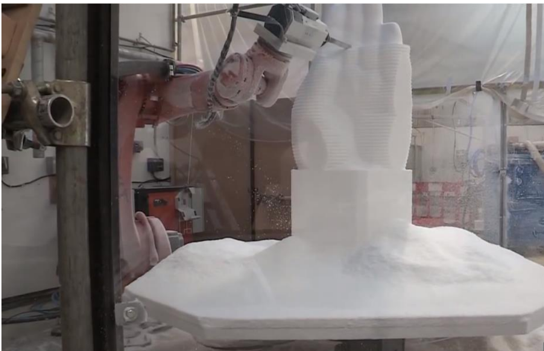
Εικόνα 24 Κατεργασία τεμαχίων με τη χρήση ρομποτικού βραχίονα και περιστρεφόμενου τραπέζιού.
