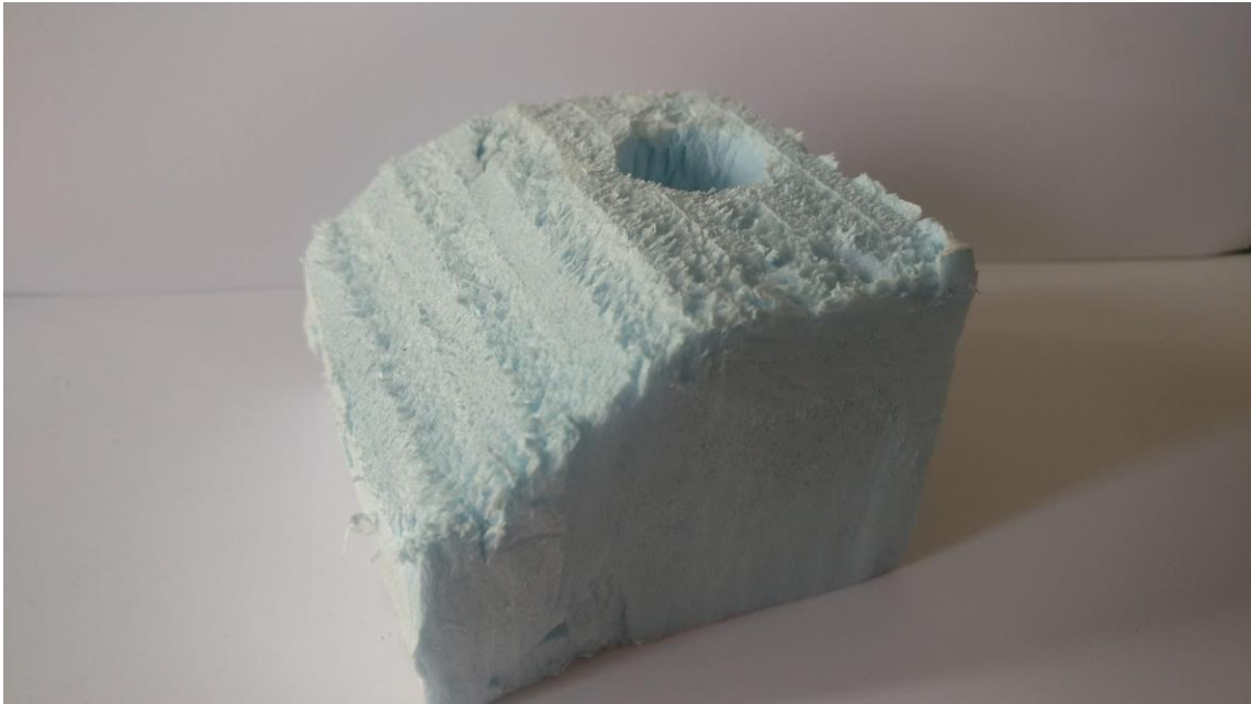
Εικόνα 57 Αποτελέσματα κατεργασίας τεσσάρων αξόνων και τη χρήση κυκλικών κινήσεων.
