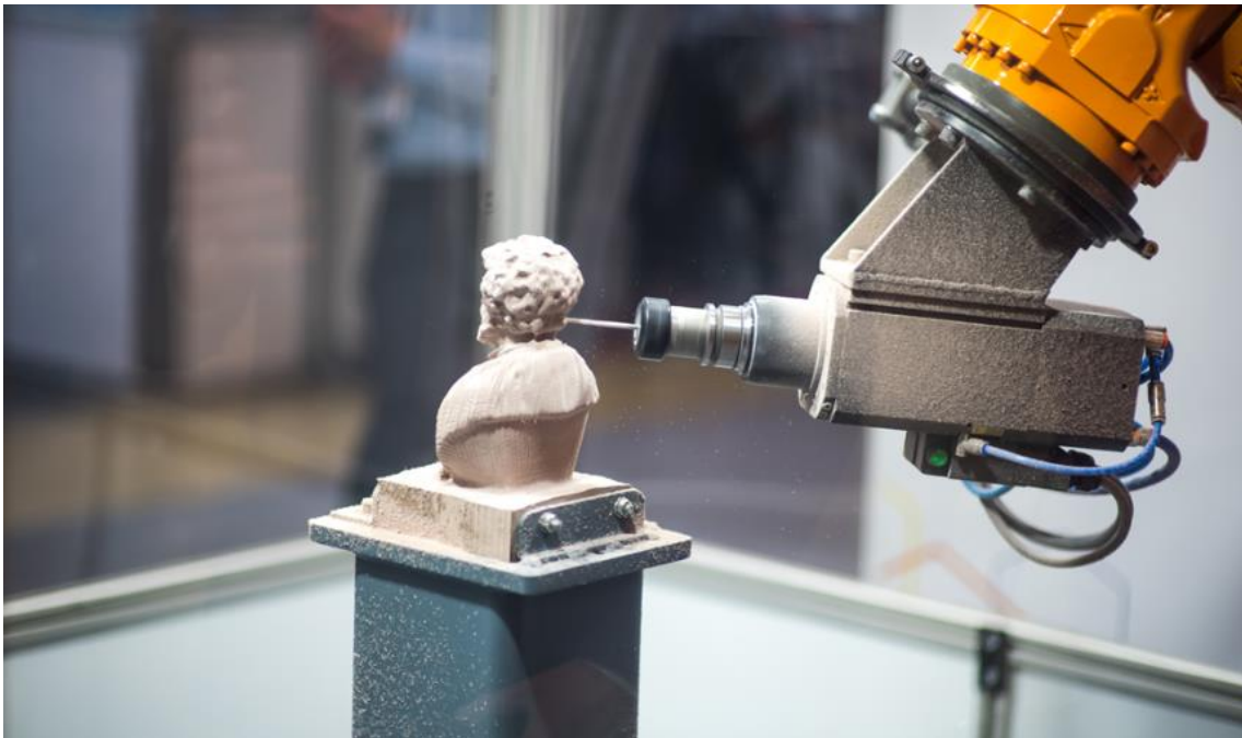
Εικόνα 16 Κατεργασία ξύλου για τη δημιουργία μοντέλου με τη χρήση ρομποτικού βραχίονα
