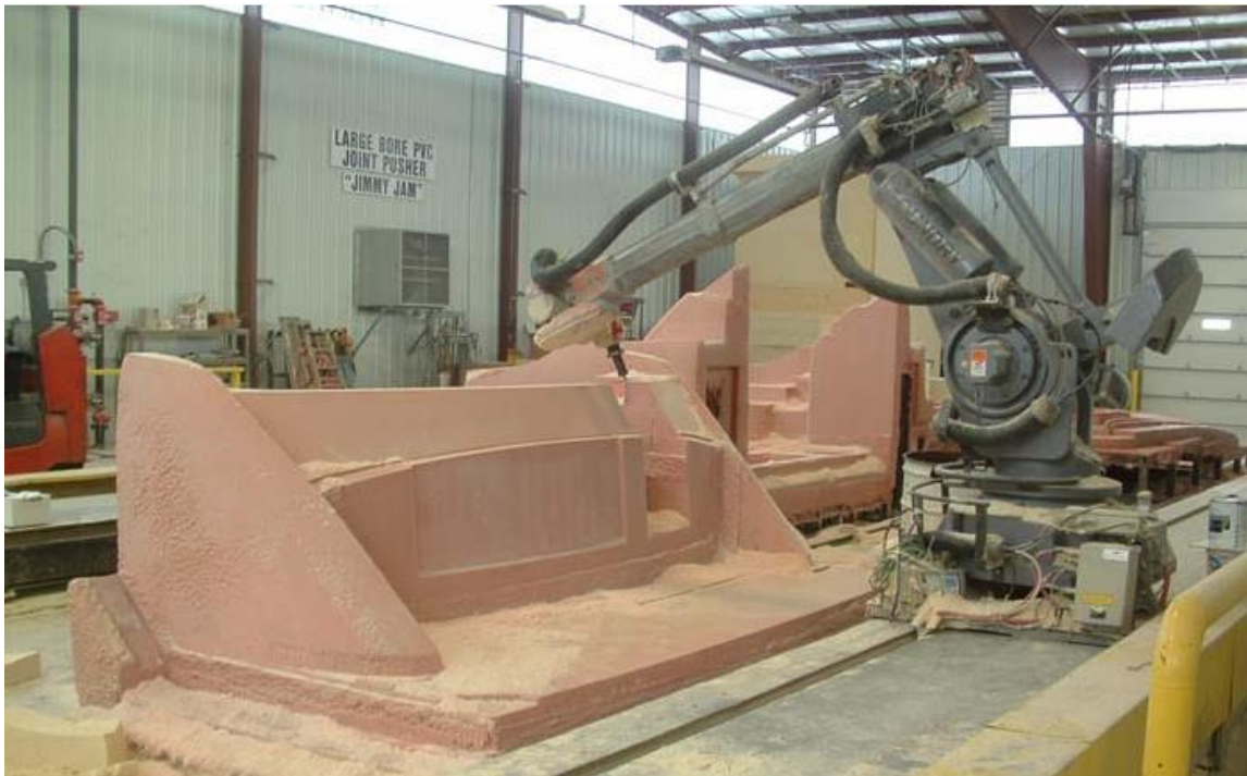
Εικόνα 20 Κατεργασία μεγάλου τεμαχίου από ξύλο με τον ρομποτικό βραχίονα μοντέλου ABB IRB 6400
