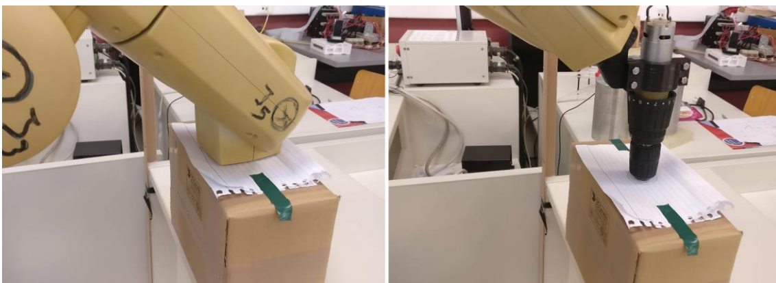
Εικόνα 39 Οι δύο καταστάσεις για τον μηδενισμό του κοπτικού. Στην αριστερή φωτογραφία ακουμπάει η φλάντζα στο σημείο μηδενισμού και στη δεξιά ακουμπάει το άκρο του τσοκ.
