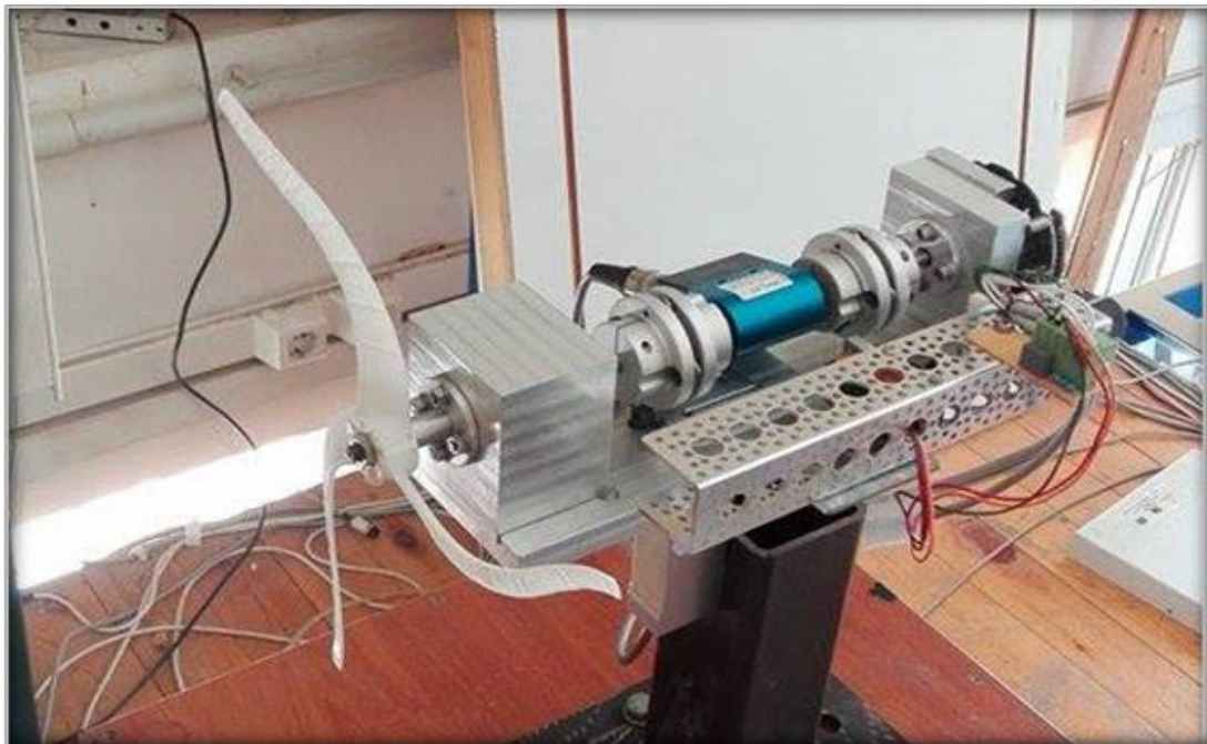
Εικόνα 1. Διάταξη μέτρησης πτερυγώσεων, σε λειτουργία.
