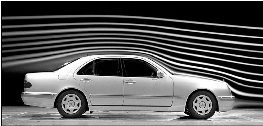
Εικόνα I.2-7. Εμφάνιση γραμμών ροής με χρήση καπνού.
