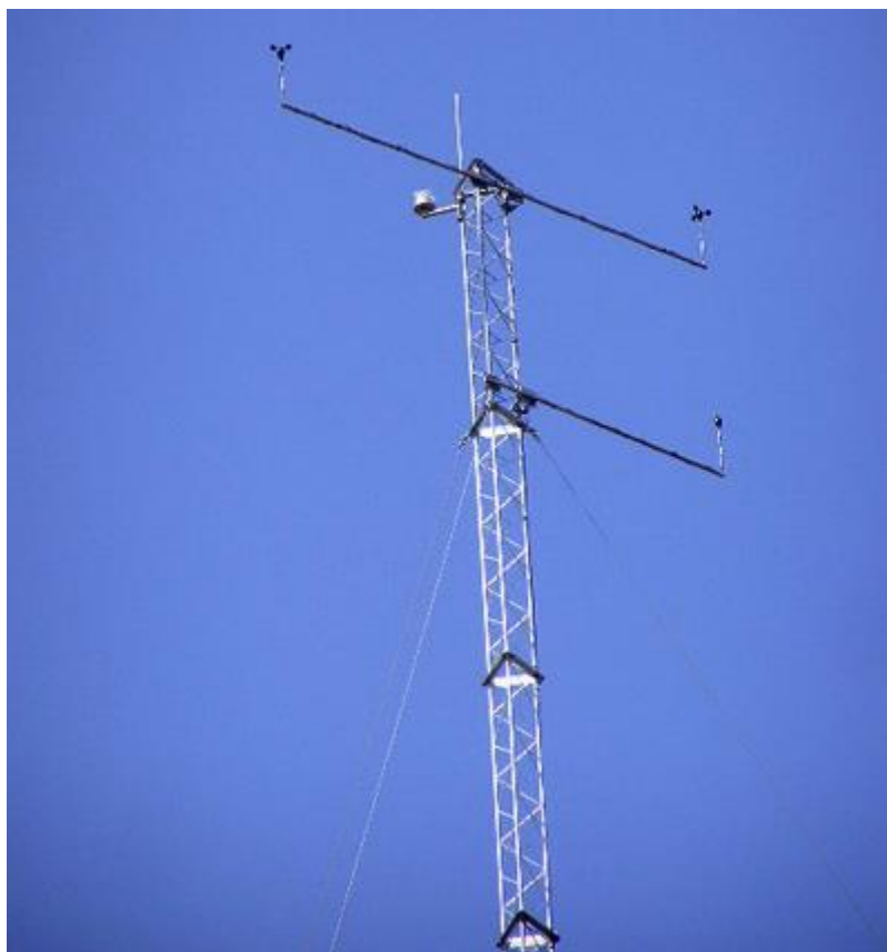
Εικόνα 3.2: Διάταξη Ανεμολογικού Ιστού 60 μέτρων με τύπου δικτυώματος.
