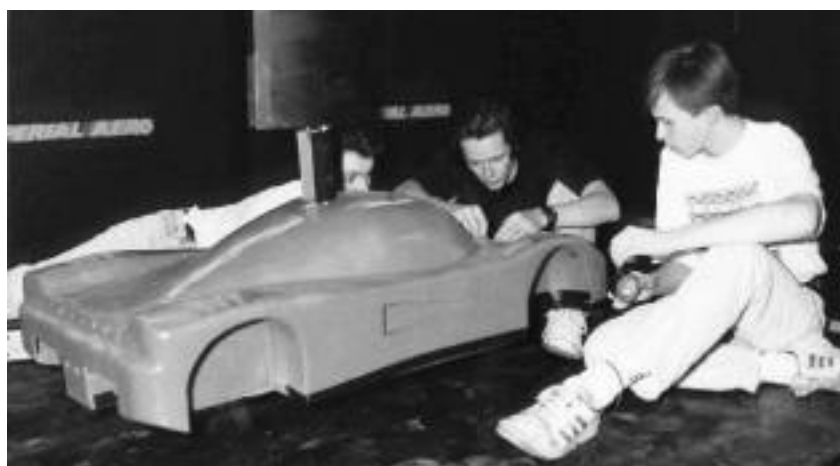
Εικόνα 1.2-1. Κατασκευή μοντέλου για αεροδυναμικές μετρήσεις.
