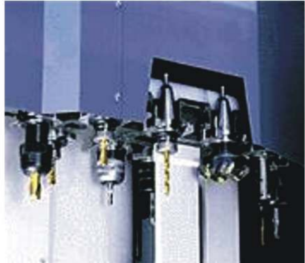
Φορέας αυτόματης αλλαγής κοπτικών εργαλείων τύπου καρουσέλ
