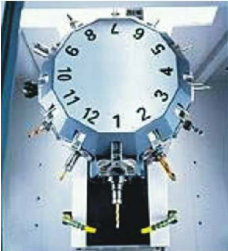
Φορέας αυτόματης αλλαγής κοπτικών εργαλείων τύπου καρουσέλ
