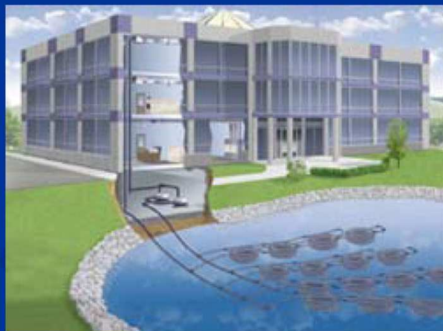
Οριζόντιο κλειστό κύκλωμα σε λίμνη ή θάλασσα
