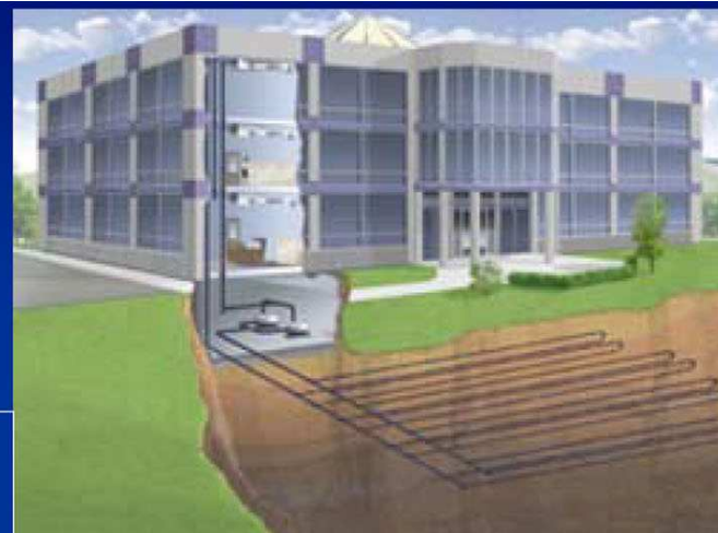
Οριζόντιο κλειστό κύκλωμα
