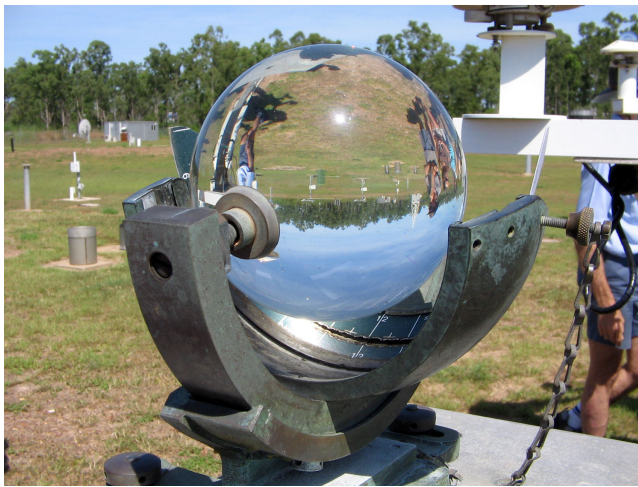
Εικόνα 35. Ηλιογράφος Campbell-Stokes. Διακρίνεται η καμένη ταινία.
