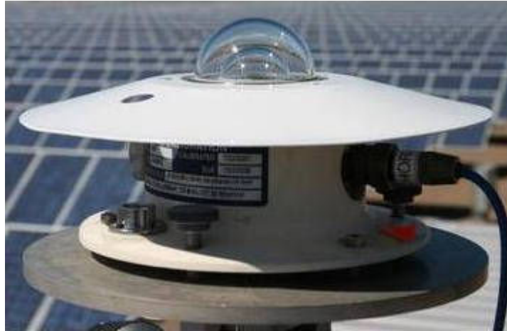
Εικόνα 32. Η εικόνα ενός πυρανομέτρου. Είναι εμφανής ο διπλός θόλος από γυαλί που προστατεύει τους αισθητήρες, καθώς και το αδιάβροχο καλώδιο από την πλευρά που μεταφέρονται τα ηλεκτρικά σήματα που αντιστοιχούν στην προσπίπτουσα ηλιακή ακτινοβολία. ( Steve Wilcox courtesy of US Department of Energy/National Renewable Energy Laboratory (US DOE/NREL).
