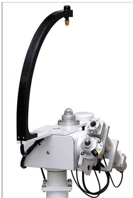
Εικόνα 31. Σύστημα πυρηλιομέτρου με πυρανόμετρο προστατευμένο από την άμεση ακτινοβολία ώστε να μετρά μόνο τη διάχυτη.
