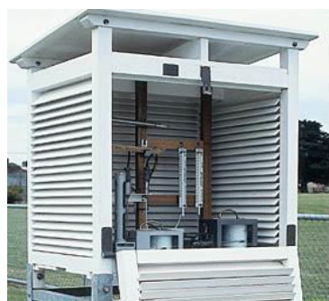
Σχήμα 1.2 Μετεωρολογικός κλωβός που φέρει εντός μετεωρολογικά όργανα για την παρακολούθηση των κλιματικών μεταβολών της ατμόσφαιρας.
