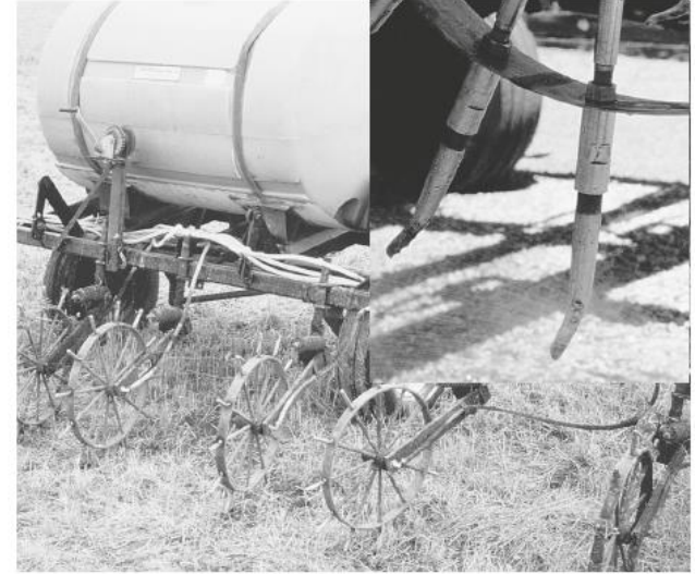
EIKONA 16.31 (Αριστερά) Αραιή λιματολόσση εγχέεται στο έδαφος σε ειδικά αυλάκια που χαράσσονται με υνί πριν τη φύτευση. Η μέθοδος της έγχυσης μειώνει την επιφανειακή απορροή και τις οσμές. Υπάρχουν και πιο ελαφριά μηχανήματα έγχυσης υγρών λιπασμάτων (δεν παρουσιάζονται). (Δεξιά) Ρόδα με καρφιά που σχεδιάστηκε για σημειακή έγχυση υγρών λιπασμάτων. [Φωτογραφία (αριστερά) από R. Weil, φωτογραφία (δεξιά) από Fluid Fertilizer Foundation]
