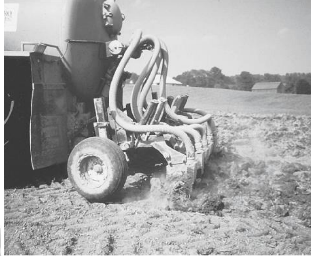
EIKONA 16.31 (Αριστερά) Αραιή λιματολόσση εγχέεται στο έδαφος σε ειδικά αυλάκια που χαράσσονται με υνί πριν τη φύτευση. Η μέθοδος της έγχυσης μειώνει την επιφανειακή απορροή και τις οσμές. Υπάρχουν και πιο ελαφριά μηχανήματα έγχυσης υγρών λιπασμάτων (δεν παρουσιάζονται). (Δεξιά) Ρόδα με καρφιά που σχεδιάστηκε για σημειακή έγχυση υγρών λιπασμάτων. [Φωτογραφία (αριστερά) από R. Weil, φωτογραφία (δεξιά) από Fluid Fertilizer Foundation]
