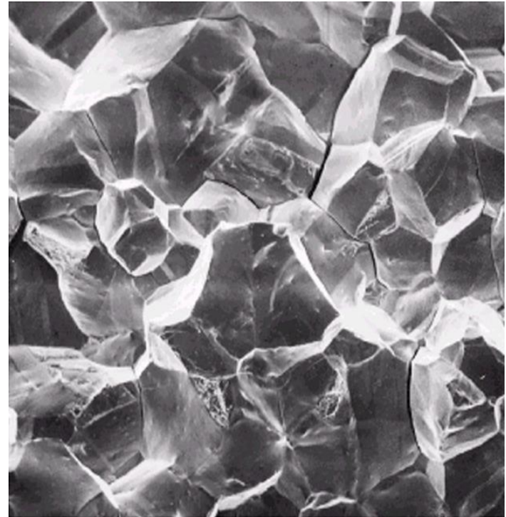
Θραυστοφωτογραφία ηλεκτρονικού μικροσκοπίου επιφάνειας διακρυσταλλικής θραύσης.50x
