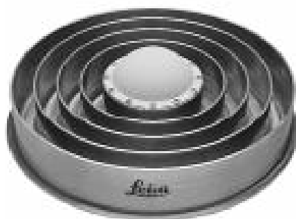
Σχήμα 3.11: Το Choke Ring που χρησιμοποιείται για την ελαχιστοποίηση του φαινομένου της πολυδιαδρομής στους δέκτες GPS.
