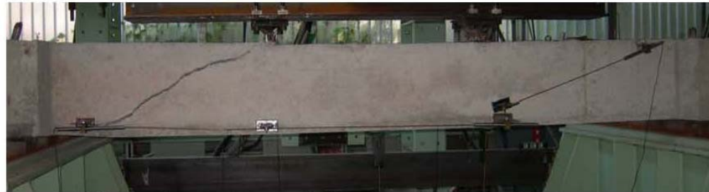
(β) Ρηγματώσεις του δοκμίου SVS μετά το πέρας της διαδικασίας φόρτισης
