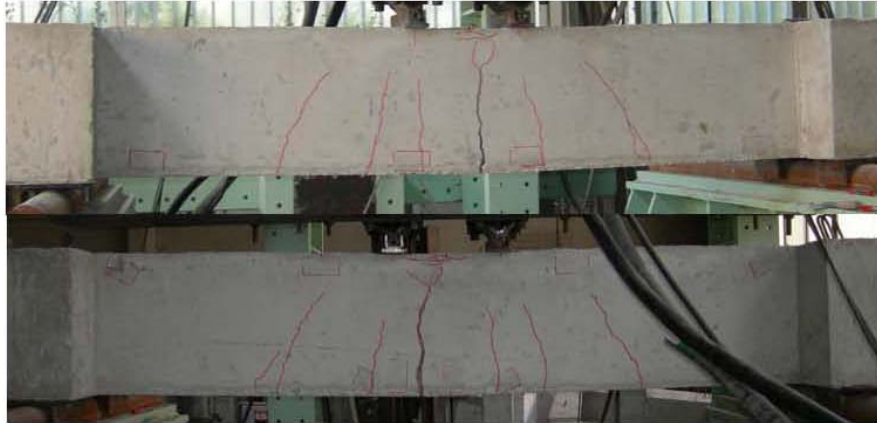
(β) Ρηγματώσεις του δοκιμίου IVM μετά το πέρας της διαδικασίας φόρτισης
