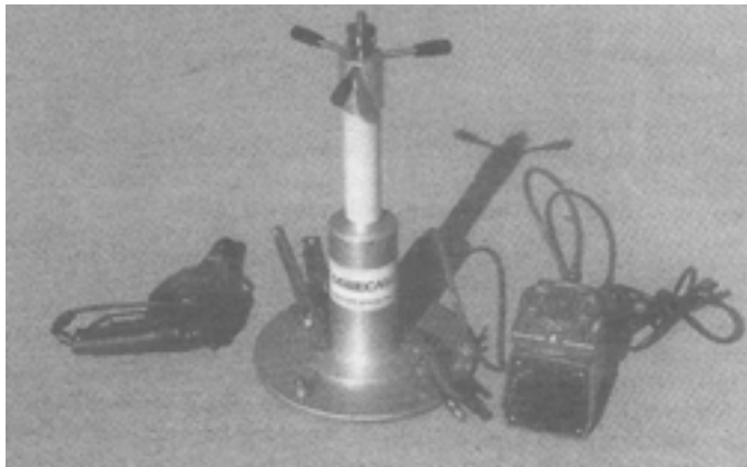
Σχήμα 2.13.: Σύστημα λήψης πυρήνων σκυροδέματος.
