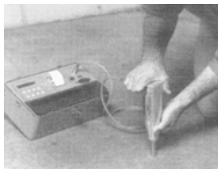
Σχήμα 2.9.: Ηλεκτρονικό κρουσίμετρο με εκτυπωτή αποτελεσμάτων.
