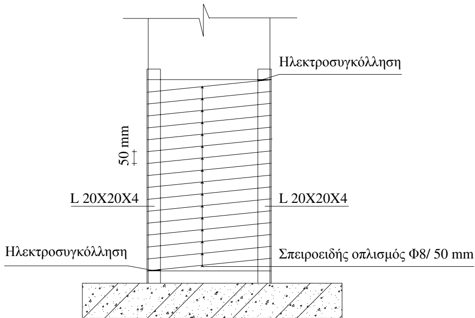
Σχήμα 1.6 Περίσφιγξη με σπειροειδή οπλισμό
