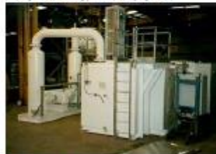
Καταλυτικός μετακαυστήρας VOC.
