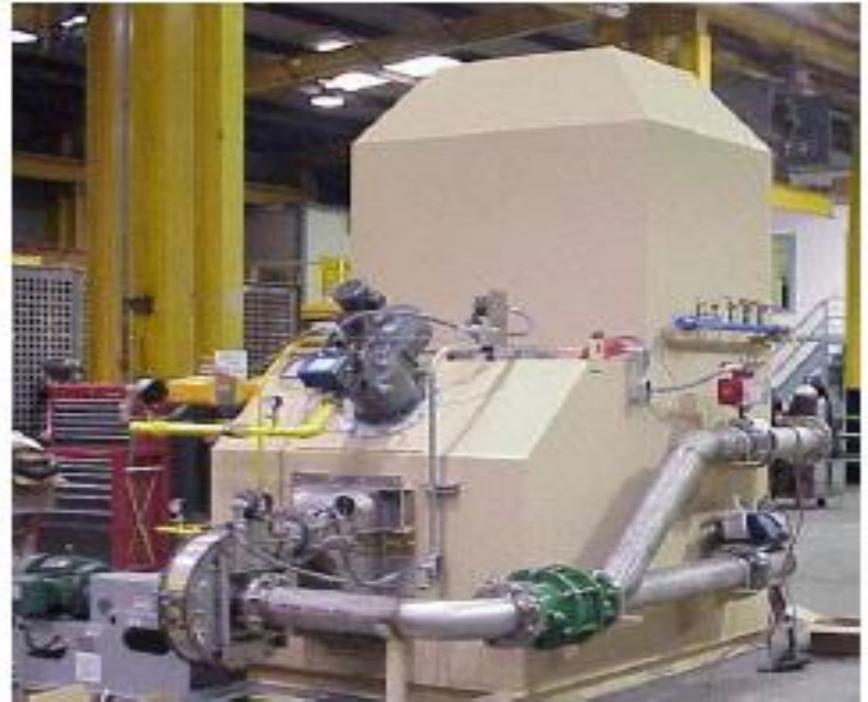
Θερμικός μετακαυστήρας VOC.
