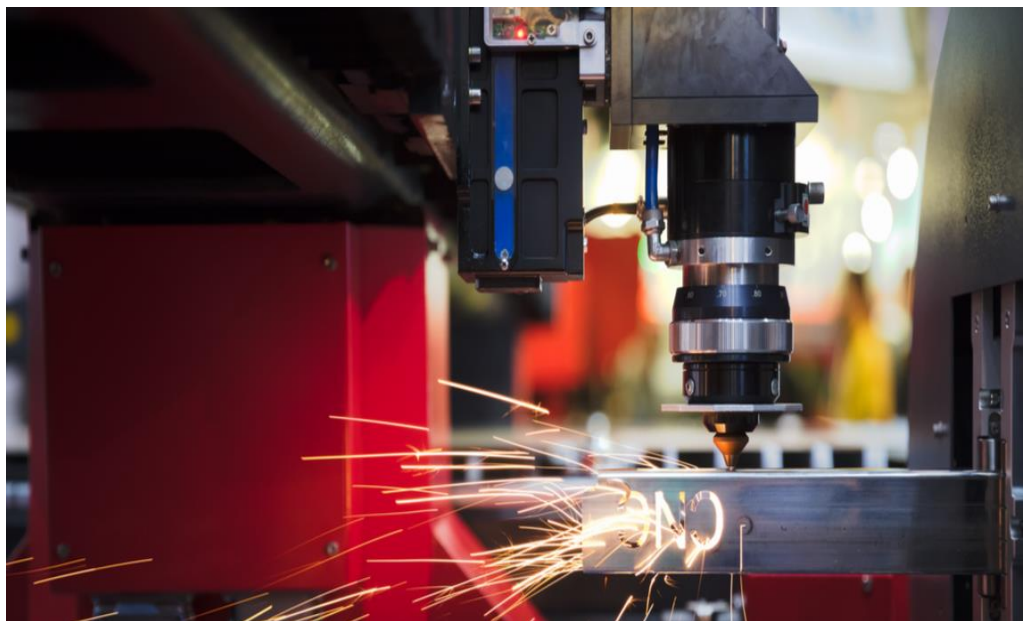
Σχήμα 6.5.3: Κοπτικό εργαλείο μιας μηχανής CNC, η οποία είναι καθοδηγούμενη και λειτουργεί αντλώντας δεδομένα από τα συνεργαζόμενα λογισμικά CAD/CAM.
