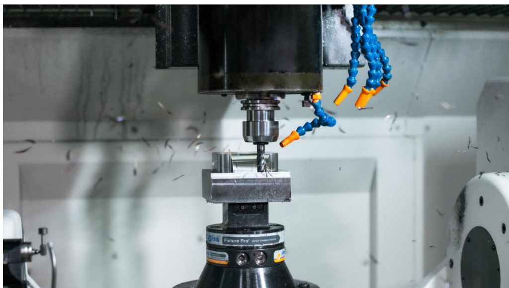
Σχήμα 6.6.6: Εργαλείο τριών αξόνων κατευθυνόμενο με την καθοδήγηση των εντολών του λογισμικού CAM, το οποίο κατατάσσεται στο πρόγραμμα Esprit.
