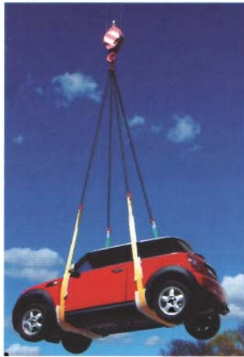
Εικόνα 2.2: Ενώ η τάση στα τέσσερα καλώδια που στηρίζουν το αυτοκίνητο δεν μπορεί να βρεθεί χρησιμοποιώντας τις τρεις εξισώσεις της (2.34), η σχέση ανάμεσα στις τάσεις μπορεί να προκύψει εξετάζοντας την ισορροπία του γάντζου.
